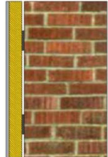
trasmittanza iniziale 1,48 W/m<sup>2</sup>K
