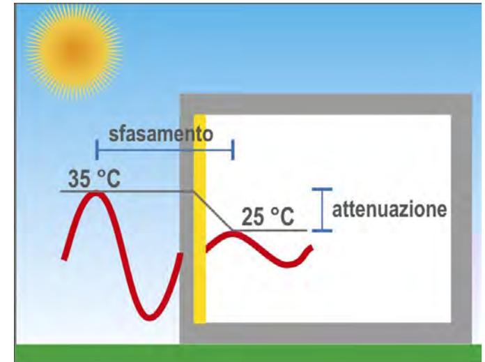
La Trasmittanza Termica Periodica -  $Y_{ie}$  - indica la capacità della parete opaca di sfasare - prestazione che dipende dalla massa della parete - ed attenuare il flusso termico che la attraversa in un giorno.
