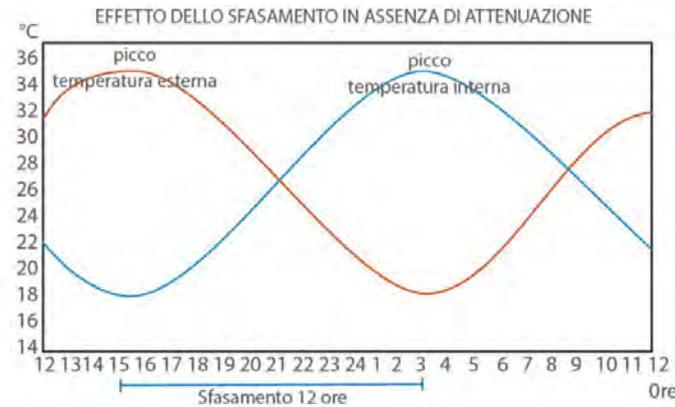
Lo sfasamento temporale in assenza di attenuazione del flusso termico non è sufficiente ad assicurare il comfort estivo (isola di calore, notti tropicali, scarsa ventilazione, ...)
