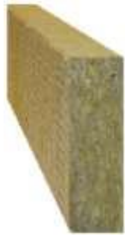
LDR Lana di roccia \lambda_d = fino a 0,036 W/(mK) Euroclasse A1
