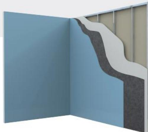
Parete tipo W111 con profilo C50/75, singola lastra GKB da 12,5 mm rivestita su 2 lati con DIAMANT® PHONO 10
