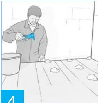
**4.** Eseguire il cordolo di adesivo continuo lungo i bordi della lastra ed applicare mucchietti di Knauf Perfix di diametro pari a circa 10/12 cm sul retro della lastra
