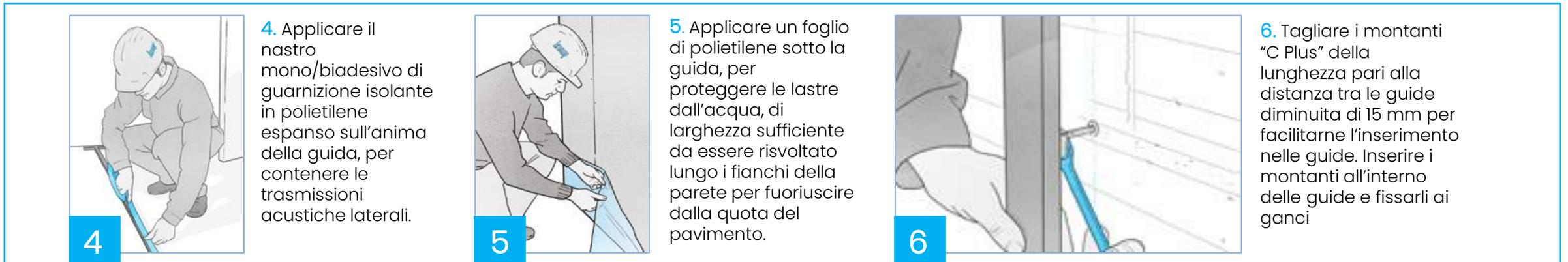
**4.** Applicare il nastro mono/biadesivo di guarnizione isolante in polietilene espanso sull'anima della guida, per contenere le trasmissioni acustiche laterali.
