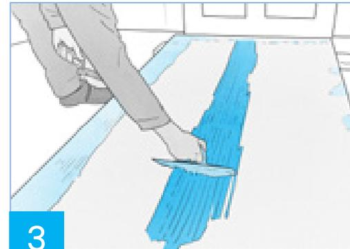
**3.** Per l'incollaggio di lastre di spessore 12,5 mm e Isolastre LM/PSE/XPS + 12,5 mm applicare un'ulteriore striscia adesiva longitudinale al centro.
