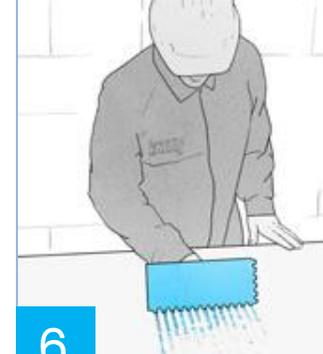
**6.** Nel caso di Isolastre PSE la superficie di applicazione dell'adesivo va grattata con dentisega prima dell'applicazione del collante
