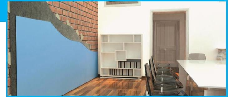
Applicazione su parete in laterizio forato da 80 mm e intonaco da 15 mm da ambo i lati con potere fonoisolante iniziale  $R_w = 41$
