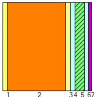
trasmittanza iniziale 1,48 W/m<sup>2</sup>K
