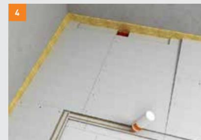
4 La battentatura di **fermacell** Powerpanel TE deve incastrarsi a livello di quella delle lastre di scolo. Incollare/avvitare l'intera lastra Powerpanel TE.
