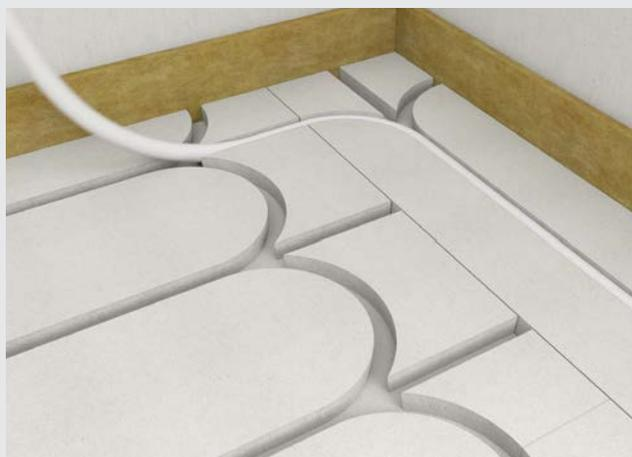
L'inserimento dei tubi di riscaldamento da 16 mm, la speciale fresatura non richiede alcun fissaggio aggiuntivo dei tubi di riscaldamento e il taglio individuale degli elementi Therm25™ consente di realizzare un'ampia varietà di situazioni di posa dei tubi anche senza gli elementi rotondi Therm25™.
