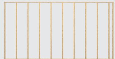
Interasse della struttura max. 500 mm
