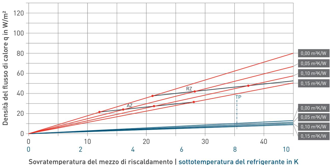
Dati di prestazione termica elemento fermacell® Therm25™
