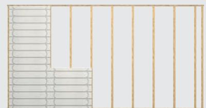
Montaggio degli elementi Therm25™ sulla sottostruttura (viti da 40 mm o graffe da 50 mm)
