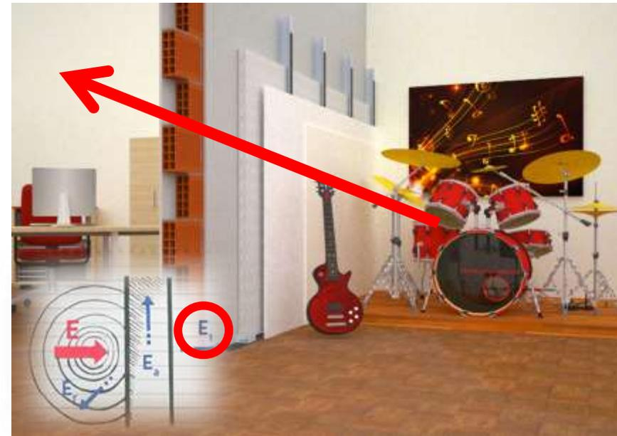
L' **ISOLAMENTO** è una limitazione della trasmissione del suono da un ambiente ad un altro.
