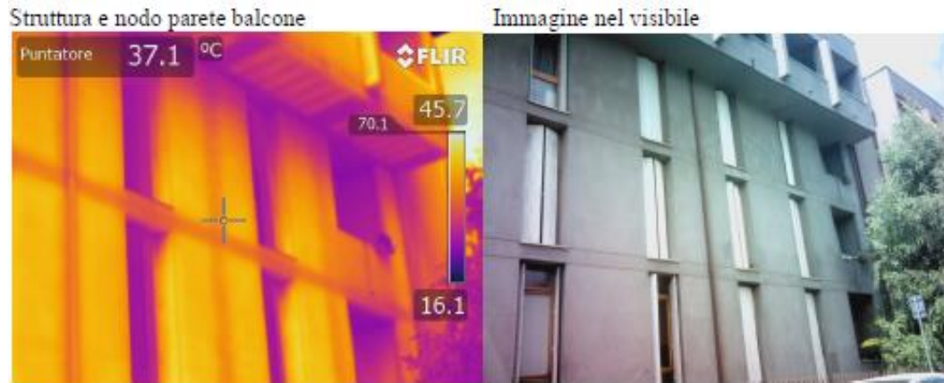
Ponti termici strutturali
