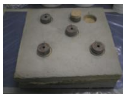
Fibra di legno Rottura pannello
