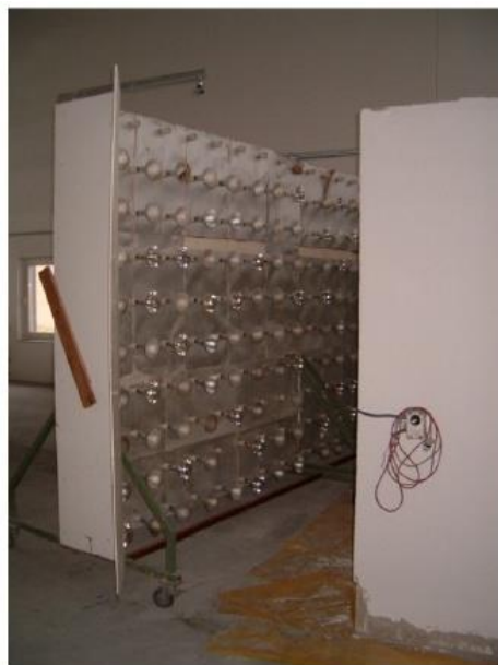
Figure 5 e 6: dispositivo sperimentale per l'esecuzione della simulazione climatica
